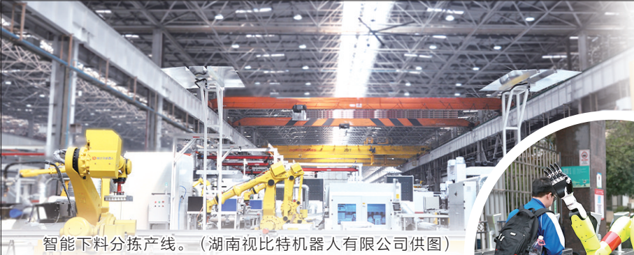
智能下料分拣产线。(湖南视比特机器人有限公司供图)
