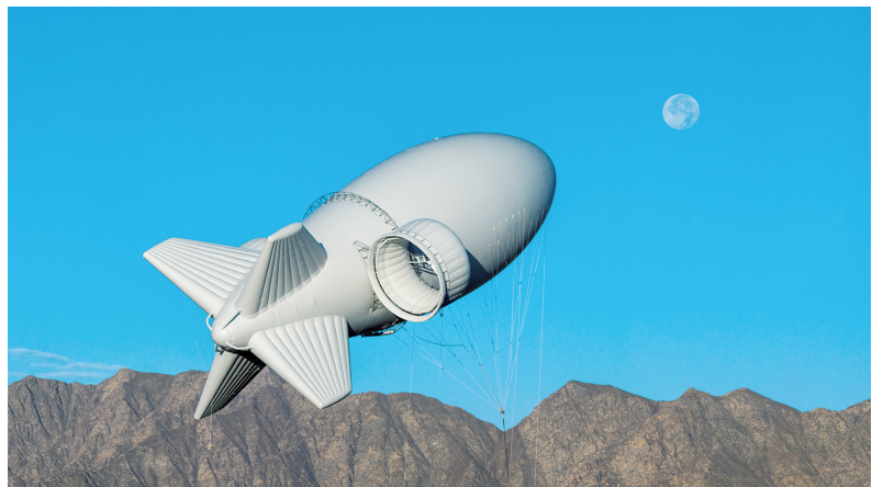
我国自主研发的S4000浮空风力发电系统近日在西北某试验基地完成升空、驻空、发电测试、平稳回收全流程放飞验证。
