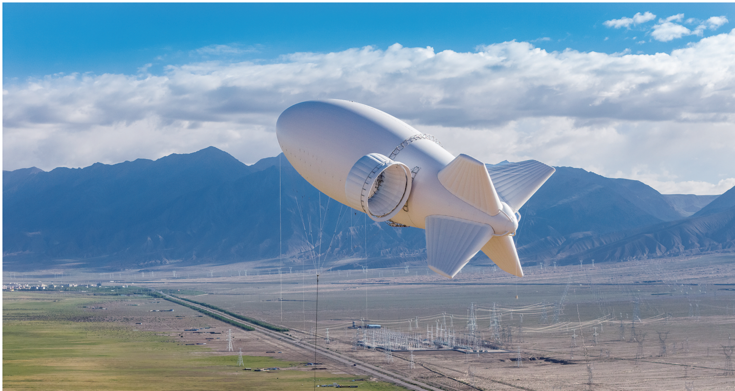
近日，我国自主研制的S4000浮空风力发电系统在西北某试验基地完成升空、驻空、发电测试、平稳回收全流程放飞验证。
