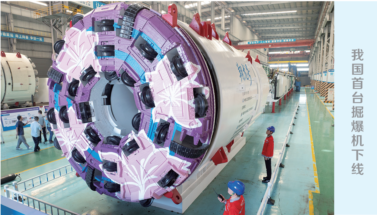
8月1日，我国首台掘爆机“翔龙号”在湖北省武汉市中铁科工江夏制造基地下线。这款装备融合掘进法与钻爆法两大主流工法，填补了复杂地质隧道一体化施工装备领域的空白。图为当日拍摄的掘爆机“翔龙号”(无人机照片)。
