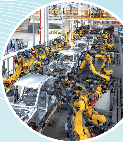
湖南长沙比亚迪雨花工厂,智能化生产线上的机械臂伸缩旋转,有条不紊地完成焊接工作。 辜鹏博 摄
