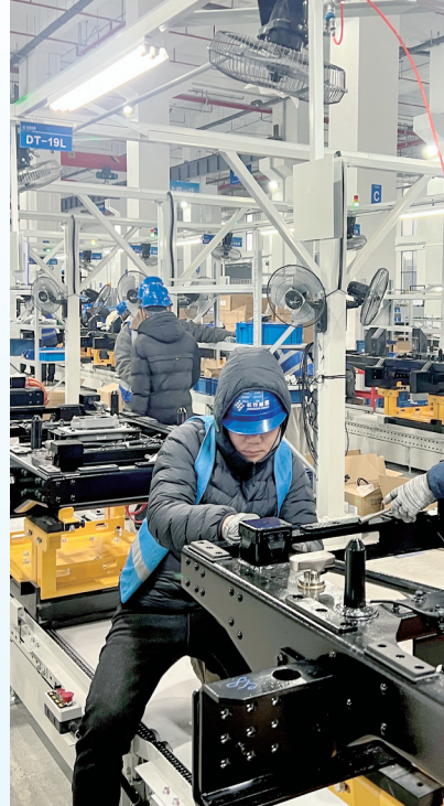
岳阳玖行能源科技有限公司生产车间，工人在生产新能源重卡换电系统智能制造产品。
