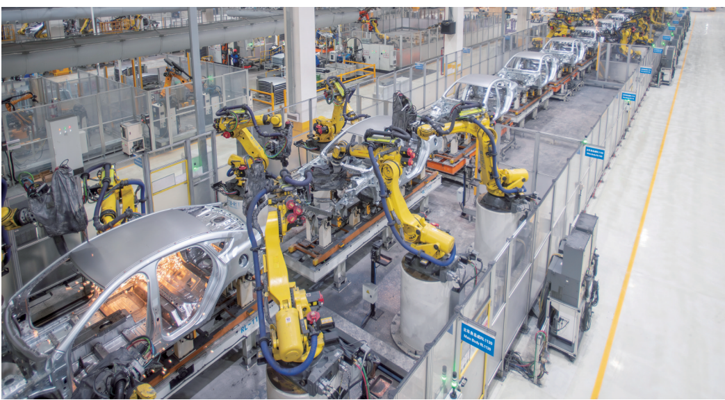
长沙比亚迪雨花基地焊装工厂,智能化生产线上的机械臂伸缩旋转,有条不紊地完成焊接工作。(资料图片) 湖南日报全媒体记者 辜鹏博 摄
