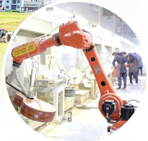
3月19日，东安县吉他产业园内智能机械臂为制作好的吉他抛光打磨。严洁 摄
