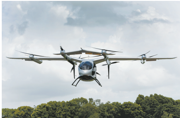
7月22日,我国首架获颁“适航三证”(TC-PC和AC)的吨级以上eVTOL(电动垂直起降)航空器V2000CG凯瑞鸥交付。V2000CG凯瑞鸥最大起飞重量2吨,最大商载400公斤,巡航速度最高200公里每小时,适用航程200公里,主要用于低空物流、紧急物资运输和应急救援。图为在飞行测试基地进行飞行演示的V2000CG凯瑞鸥电动垂直起降航空器(7月22日摄)。 新华社 发
