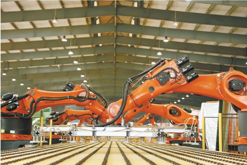
湖南家兴新材料有限公司，机械臂在装卸玻璃。
