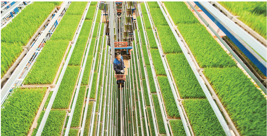
3月26日，长沙县春华镇智能化育秧工厂，6台高大的循环立体育秧床上，一盘盘绿油油的秧苗长势正好，这些层层叠叠的育秧盘可上下往复，均匀接受光照和水肥滋养。
