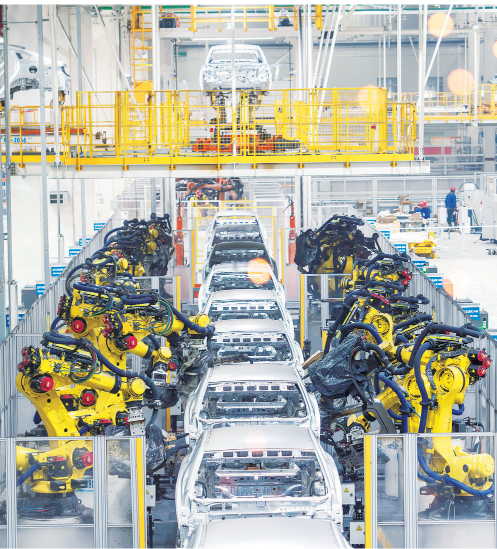
▶3月13日,长沙比亚迪雨花基地焊装工厂,智能化生产线上的机械臂伸缩旋转,有条不紊地完成焊接工作。长沙比亚迪不断探索科技成果孵化、转化,助推高质量发展。湖南日报全媒体记者 辜鹏博 通讯员 张伟 摄影报道
