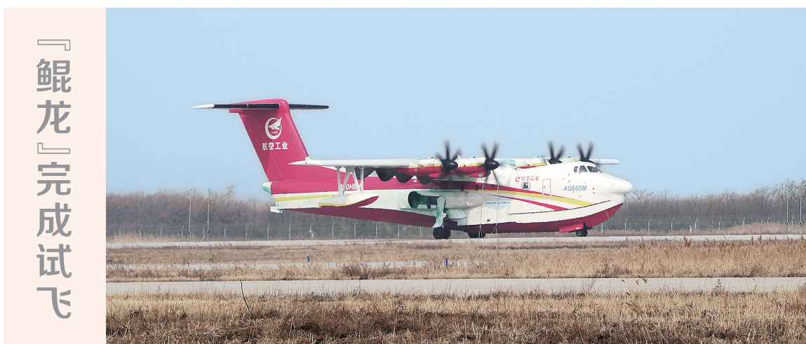
2月28日，大型水陆两栖飞机AG600“鲲龙”取证前全部试飞科目圆满完成，向取得型号合格证的目标迈出关键一步。图为当日，AG600“鲲龙”在陕西蒲城完成可燃液体排放表明符合性试飞。
