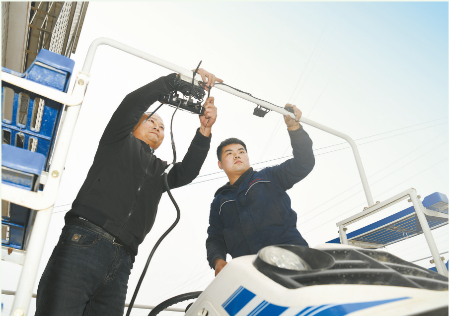
2月21日,长沙市望城区桥驿镇禾丰村,技术人员在为农业机械安装全程机械化作业探测系统。该系统利用北斗定位和物联网等先进技术,可使农机作业时位置信息更精准,从而提高作业效率。
