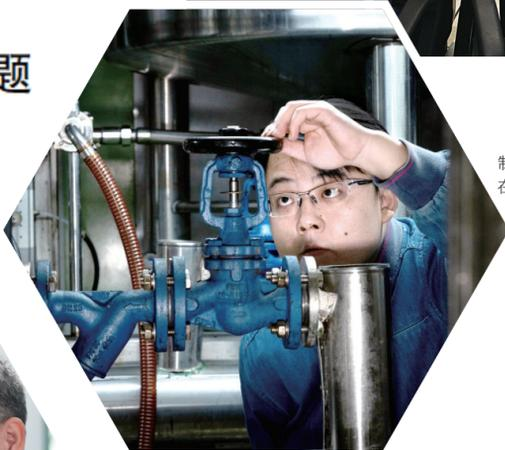
零陵卷烟厂制丝车间工艺员在检查管路阀门。
