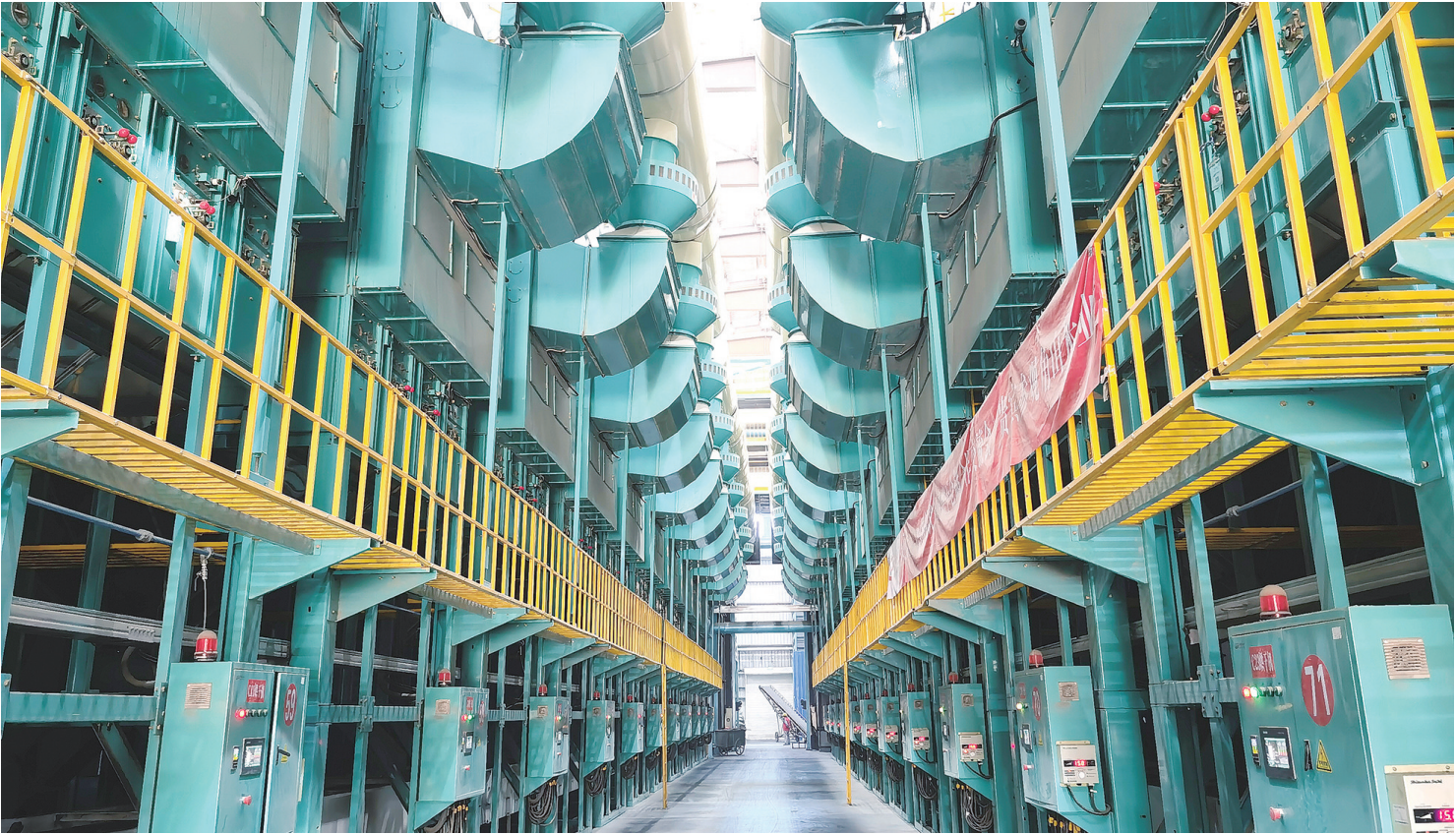
角山米业稻谷烘干区设置了6条湿稻烘干线,72组烘干机全负荷运转作业,可实现不同批次稻谷分开烘干和存放。
