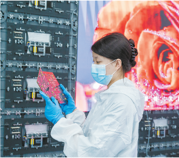
5月15日,娄底半导体显示新材料产业园湖南奥蓝新材料科技有限公司,工作人员在进行MLED显示模组调试。该产业园由湖南蓝芯微电子的MLED显示芯片、湖南奥蓝新材料科技的MLED显示模组两个子项目组成,项目达产后可年产50万片MLED核心组件、6.6万平方米MLED显示模组。吴永华 摄(湖南图片库)
