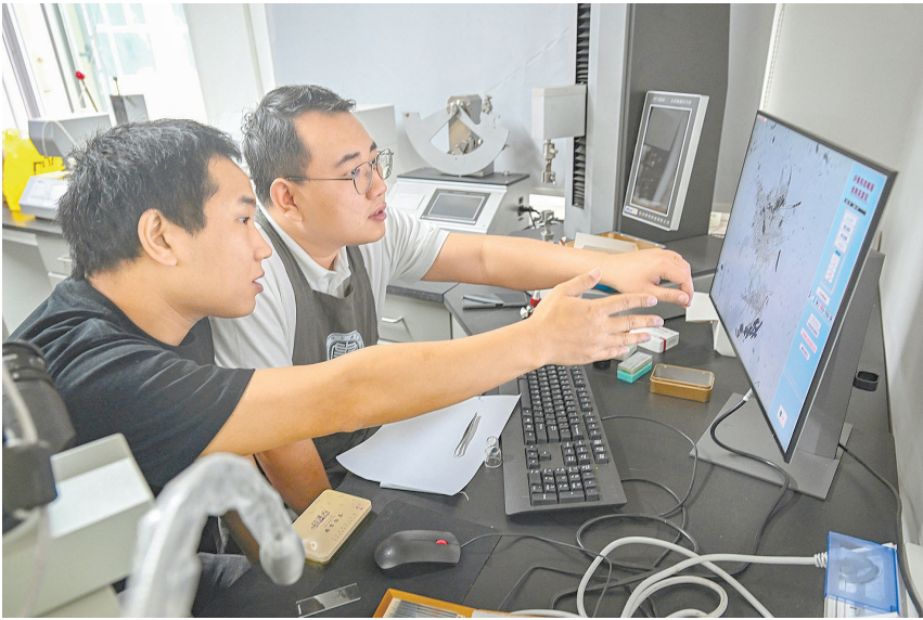
4月18日,助理导师颜胜(左)和常征一起通过显微仪器,观察纸张微观构造、纤维形态比较及鉴定,为修复纸张配比服务。
