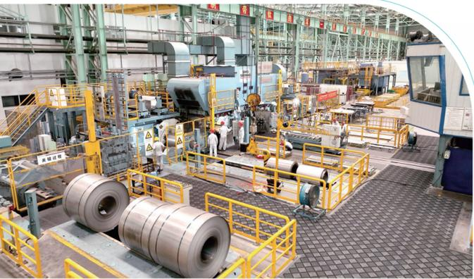
湘投金天钛金二十辊冷轧机，用于高性能宽幅钛及钛合金带卷轧制。
