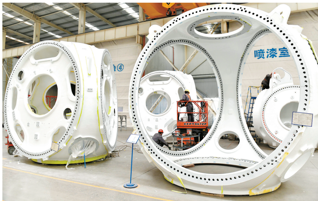
位于山东滨州市惠民县的山东国创精密机械有限公司，工作人员在对风电轮毂进行喷涂作业(1月26日摄)。 新华社发
