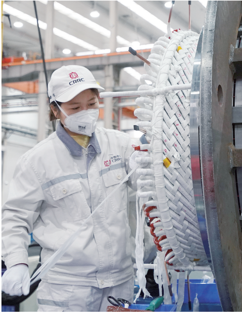
近日,江苏中车电机有限公司渌口分公司车间,工人正加快生产大功率双馈风力发电机。 湖南日报全媒体记者 张咪 摄
