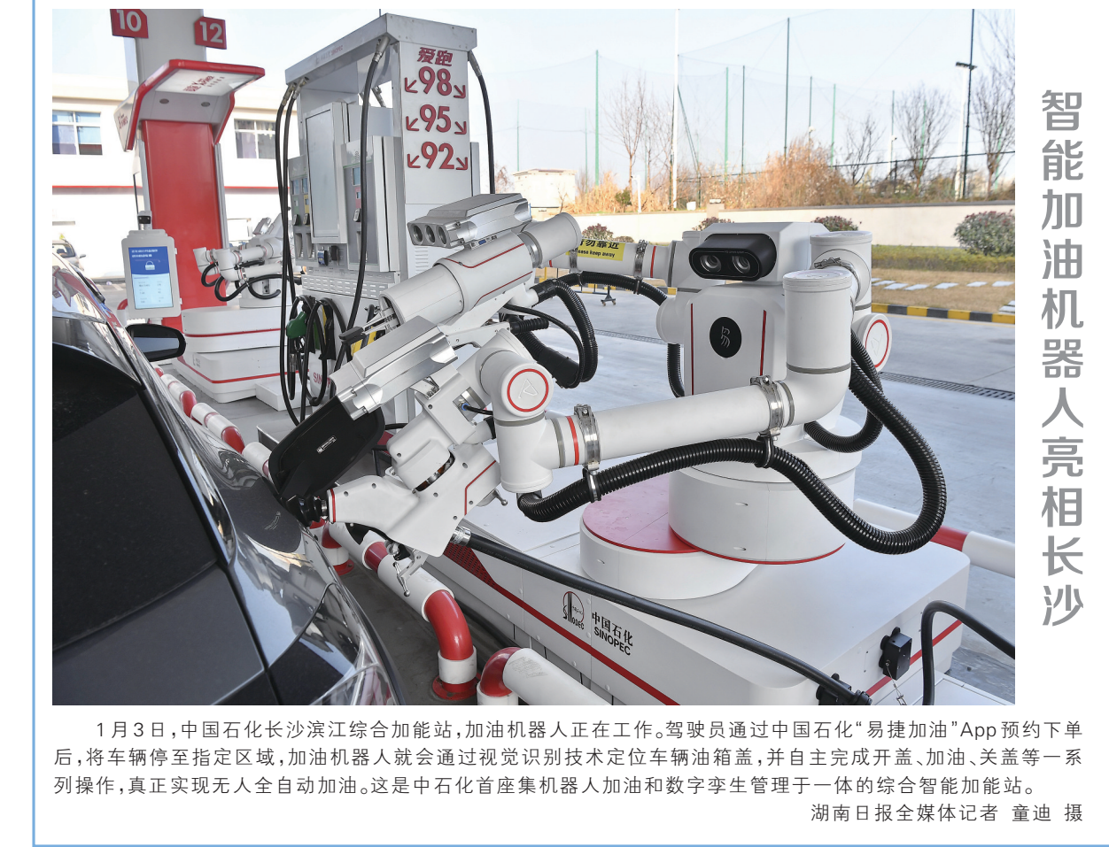
1月3日，中国石化长沙滨江综合加能站，加油机器人正在工作。驾驶员通过中国石化“易捷加油”App预约下单后，将车辆停至指定区域，加油机器人就会通过视觉识别技术定位车辆油箱盖，并自主完成开盖、加油、关盖等一系列操作，真正实现无人全自动加油。这是中石化首座集机器人加油和数字孪生管理于一体的综合智能加能站。湖南日报全媒体记者 童迪 摄
