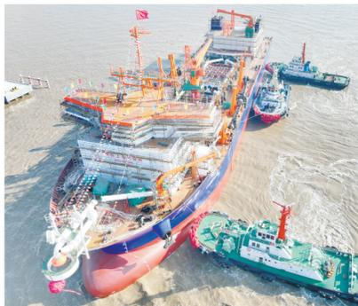
12月24日,国内首艘15000立方米舱容双燃料动力耙吸挖泥船“新海鲸”号在江苏启东顺利下水(无人机照片)。该船配备智能化“一键疏浚”和“浚驾合一”系统,可实现典型工况条件下“无人疏浚”功能。 新华社发
