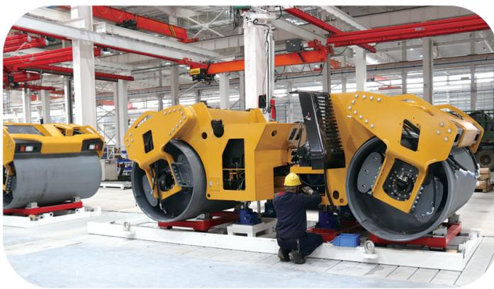
三一华源车位内,工人正在为即将“出海”的压路机安装调试液压传动装置。(娄底高新区供图)
