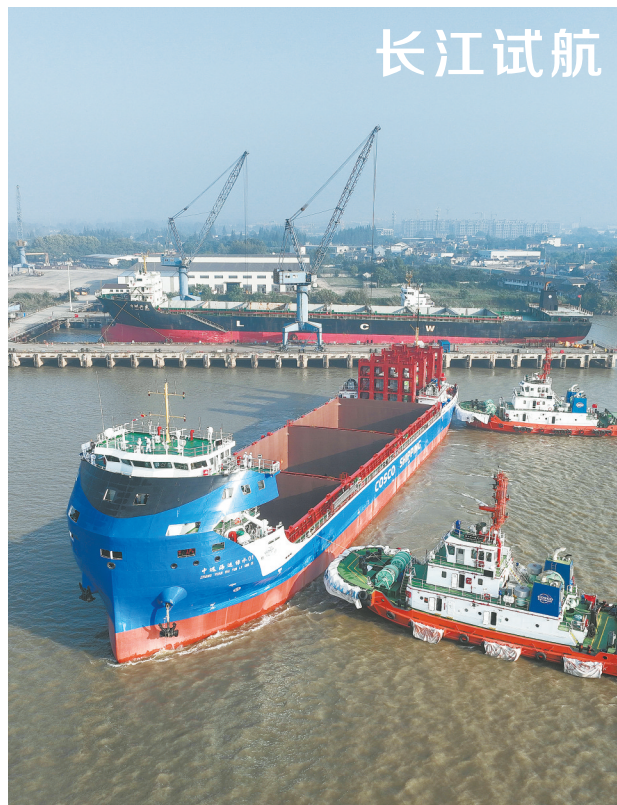
近日，由扬州中远海运重工有限公司自主设计、研发制造的万吨级电动集装箱船在长江扬州段试航。该船长119.8米，宽23.6米，可以装载700个国际标准集装箱，最高航速19.4公里/小时，设计可配备36块移动箱式磷酸铁锂电池作为动力源，电池总容量超5万千瓦时。 图为10月18日，中远海运万吨级电动集装箱船离开码头准备试航(无人机照片)。 新华社发
