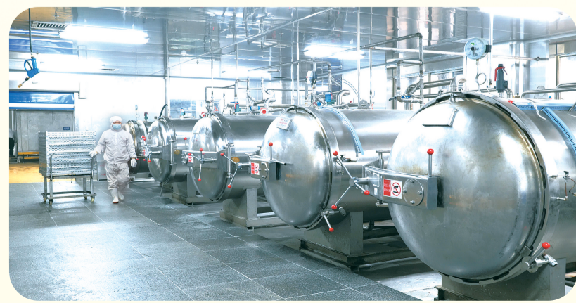
湖南新聪厨食品有限公司生产车间高温杀菌釜。（湖南新聪厨食品有限公司供图）
