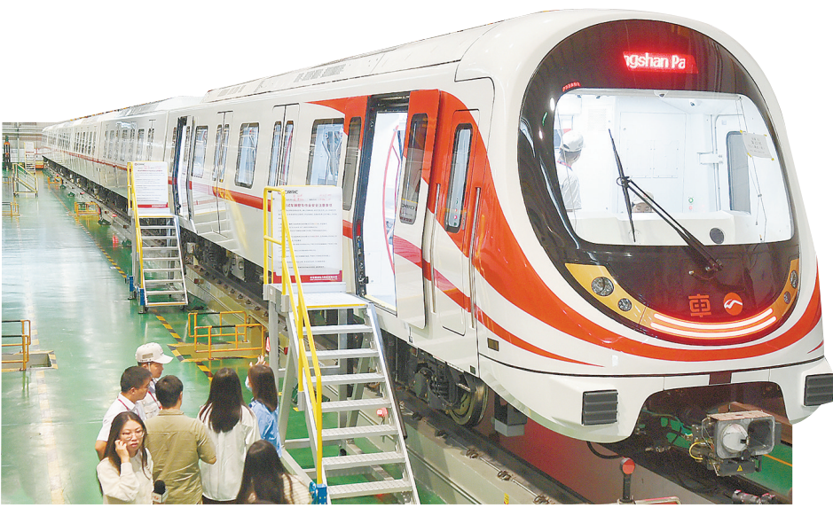
9月13日,中车株机城轨事业部总成车间,技术人员在调试新一代智慧城轨列车——中国标准地铁时速120公里B型车。该列车采用永磁同步牵引系统,较以往地铁列车节能30%。
