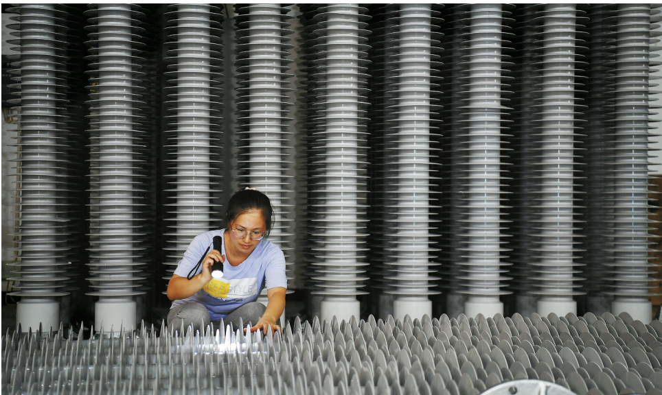
醴陵市东富工业园，湖南湖电电力设备有限公司生产车间，工人在检视产品。
