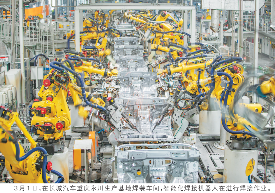
3月1日,在长城汽车重庆永川生产基地焊装车间,智能化焊接机器人正在进行焊接作业。
