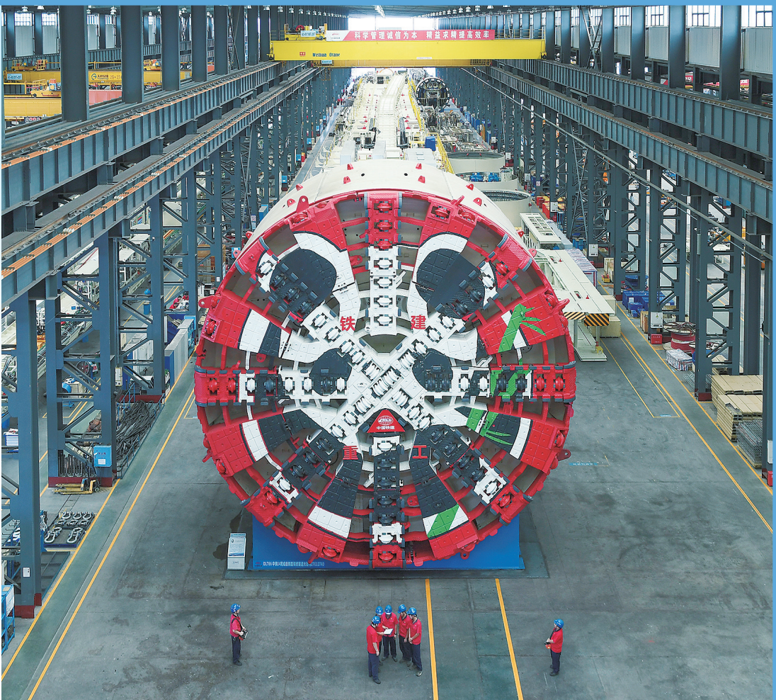
铁建重工集团长沙第二产业园，国产土压平衡盾构机“锦绣号”。 湖南日报全媒体记者 辜鹏博 摄
