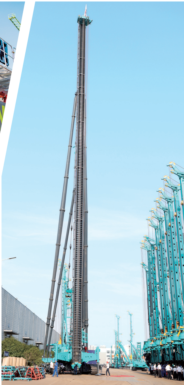
山河智能SWCH980-260M超级全液压履带桩架。陈晖莉 摄
