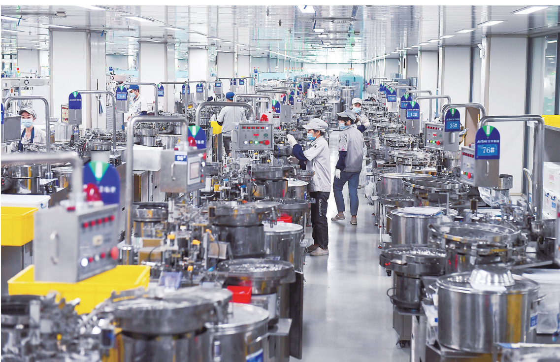
益阳龙岭产业开发区智能化数字工厂,工人利用组立设备生产铝电解电容器。
