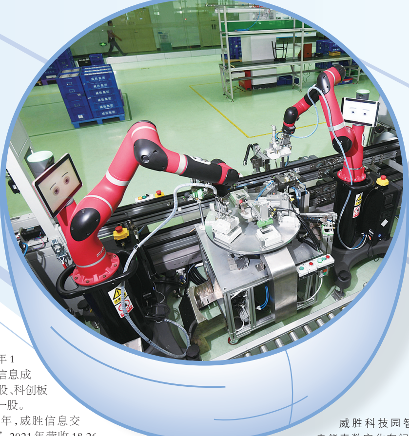
威胜科技园智能电表数字化车间，机器人在生产产品。
