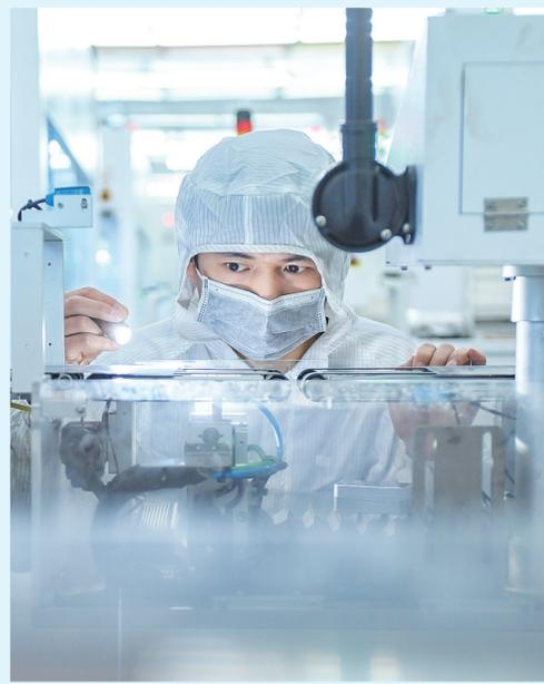
长沙高新区，湖南红太阳光电科技有限公司600MW单晶PERC智能生产车间内，工人检查电池片质量。
