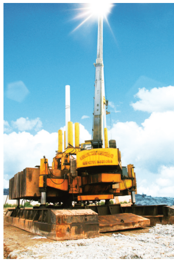
山河智能研制的新一代全液压静力压桩机。
