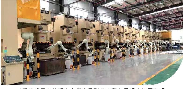
炎陵高新区内的湖南全康电子科技有限公司钣金冲压车间。42台全自动智能机械手正在加紧作业，年产量可达400万件。
