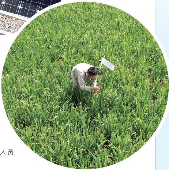
设置在田野上的虫情测报灯，可以对病虫害进行拍照并上传，便于植保。刘頌 摄
