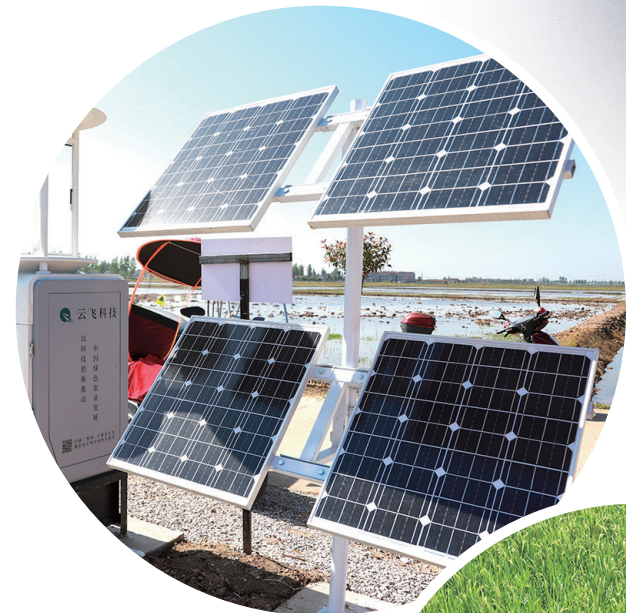
设置在田野上的虫情测报灯，可以对病虫害进行拍照并上传，便于植保。刘頌 摄
