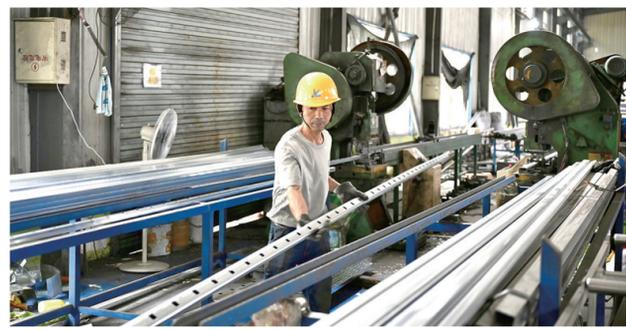
常德市城区90%在建楼盘使用奥力新材料生产的百叶窗、楼梯扶手和阳台栏杆等产品。图为奥力新材料工人正在给钢材打孔。 卜云 摄
