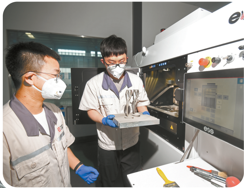
上图：6月11日，株洲国创轨道科技有限公司，技术人员利用3D打印制作机车制动装置零配件。 左图：6月16日，中车株洲电力机车有限公司，技术人员在对出口欧洲的双层动车组进行调试。 本版图片均由湖南日报·新湖南客户端记者 田超 摄
