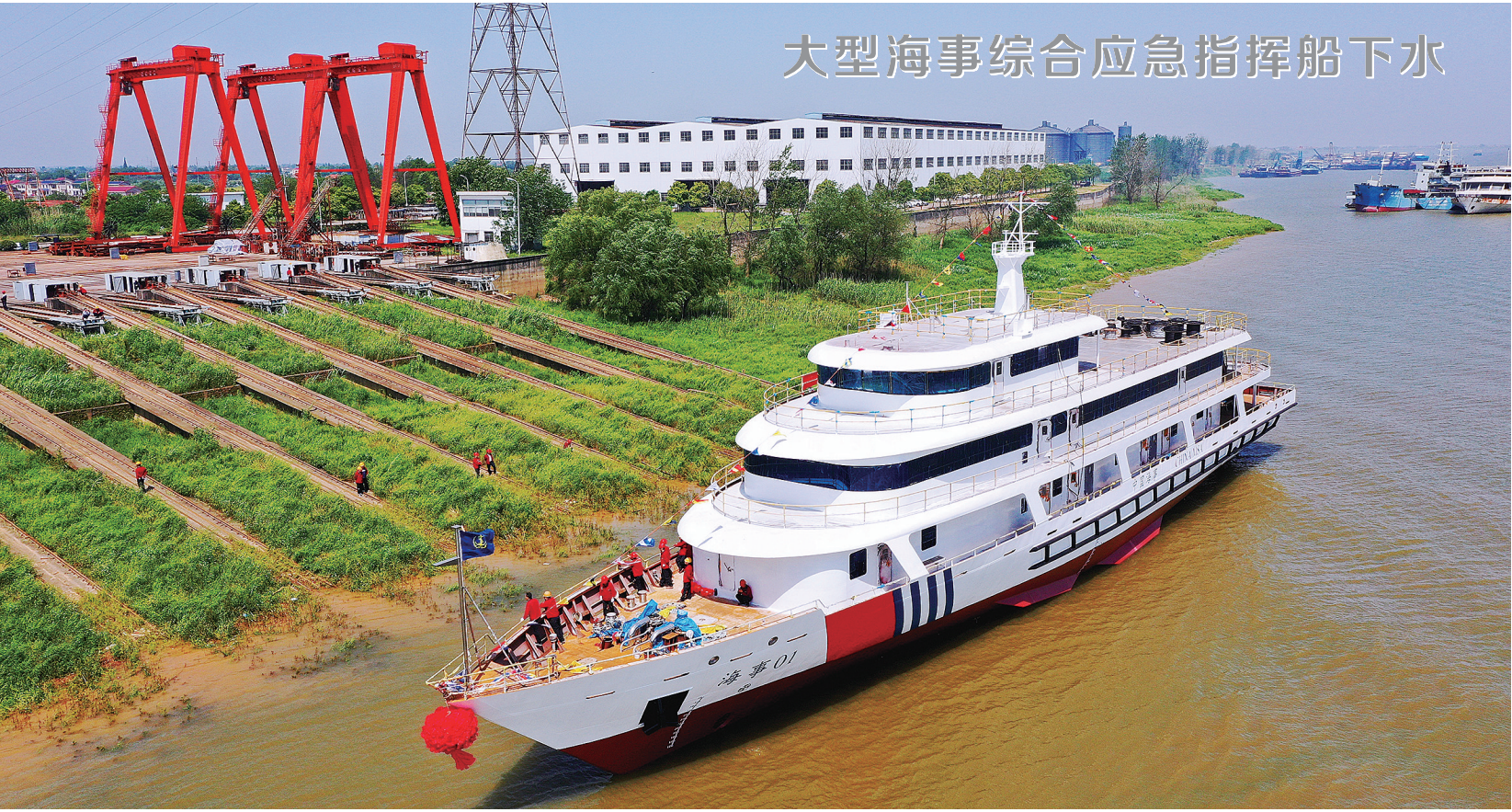
4月30日，湖南湘船重工有限公司露天船台，“海事01”60米级综合应急指挥船缓缓下水。该船具备较强的智能化、信息化功能，主要用于长江中下游水域水上重大交通事故、污染事故等突发事件的应急指挥，水上重点工程和重大活动的现场调度，下水后还将继续进行舾装、试航、验收等环节，计划6月底交付使用。
