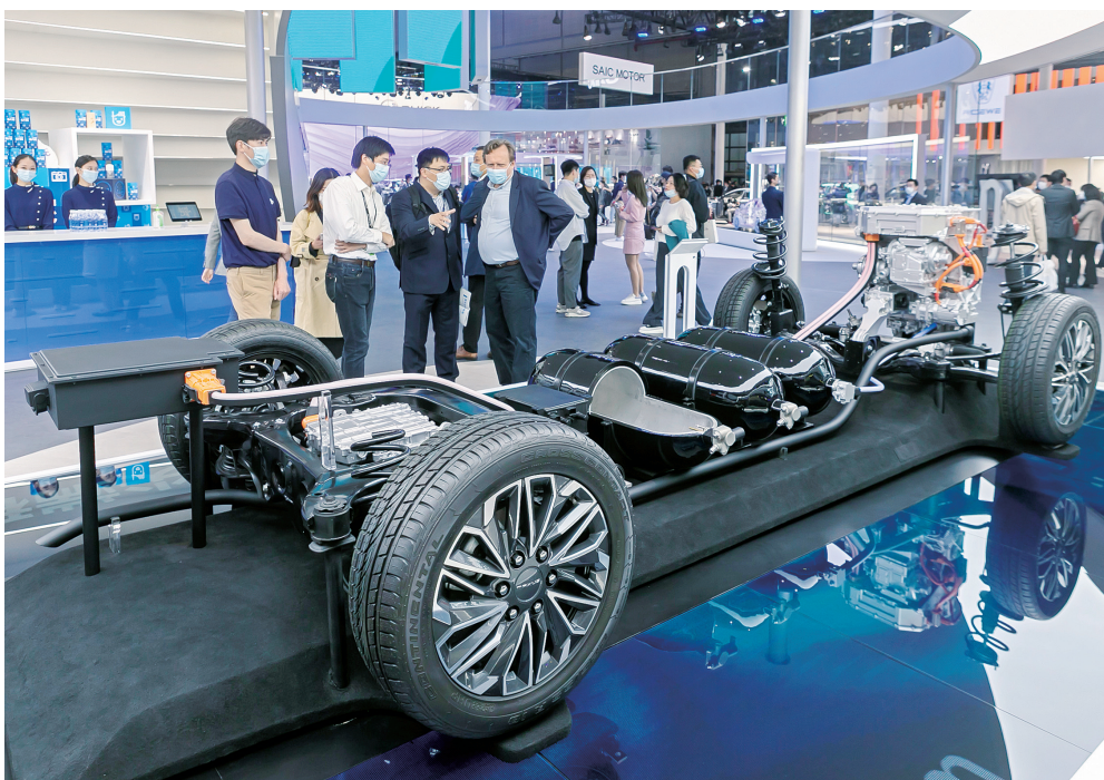
4月19日，在第十九届上海国际汽车工业展览会上，低碳环保的新能源车型成为各大厂商的明星产品，受到参观者的关注。图为上汽大通MAXUS展台拍摄的氢燃料电池MPV产品EUNIQ 7的底盘。
