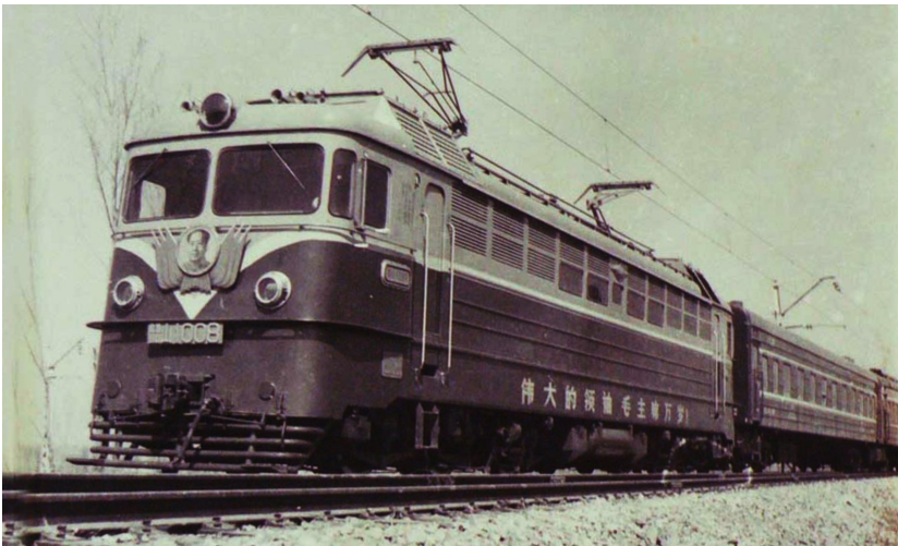
1968年3月，6Y1型8号电力机车试制成功，定型为韶山1型。（资料照片）
