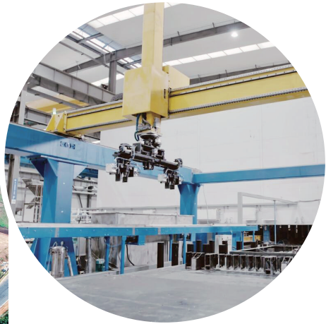
智能化墙板构件钢筋骨架自动组合成型生产线·壹模机器人
